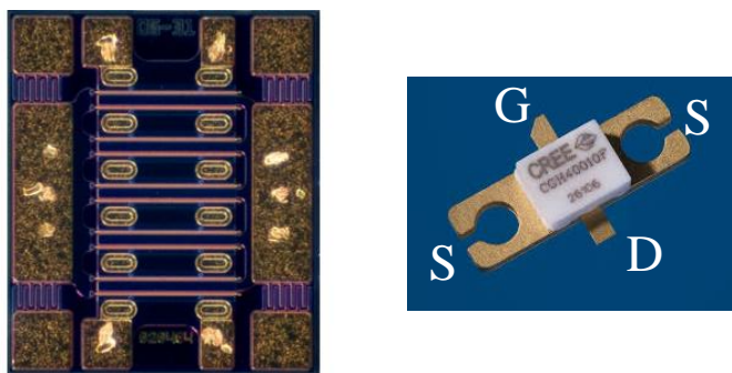
FIGURE III.1 – Photographie de la puce du transistor CGH40010F et du boîtier céramique posé sur la semelle métallique (flange).
