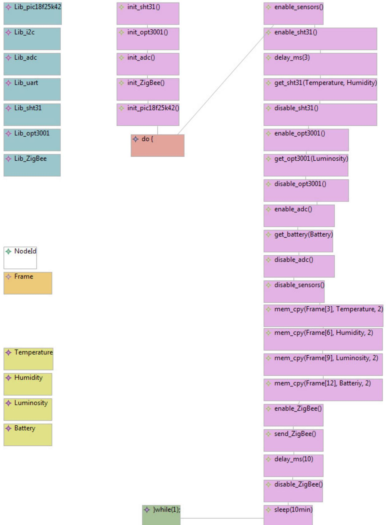
FIGURE 5.21 – Le macrocode pour la génération de code de notre nœud capteur.
