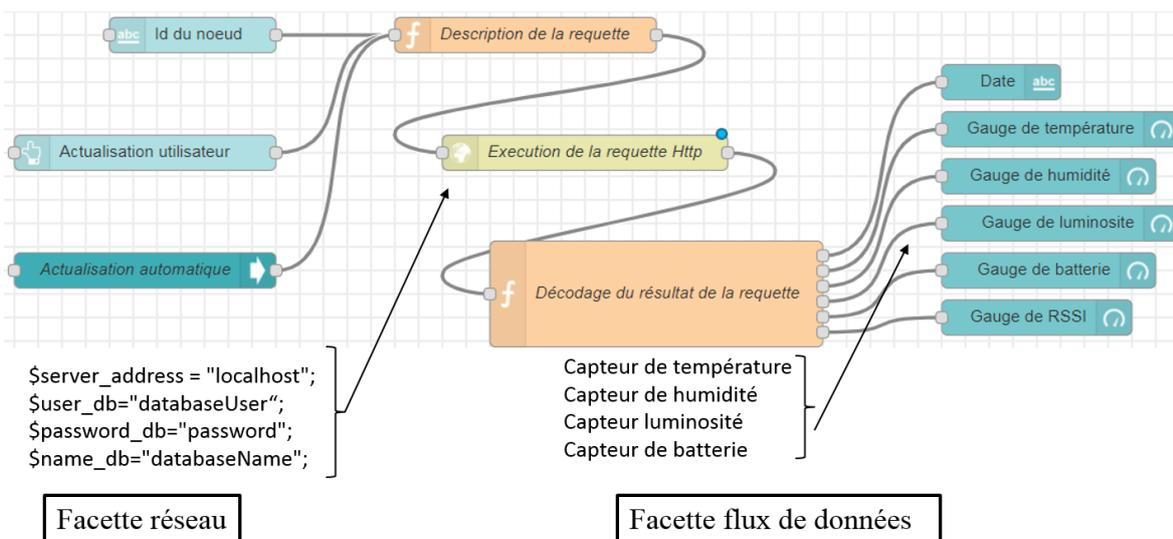
FIGURE 5.25 – Modèle de flux sous Node-RED qui permet de décrire la vue capteur.
