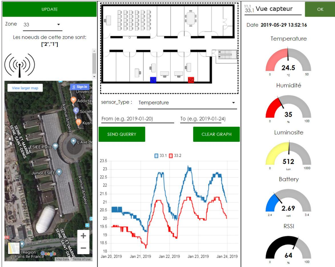
FIGURE 5.24 – Interface sous Node-RED pour visualiser les données des capteurs par rapport à une zone.
