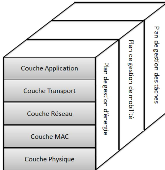
FIGURE 1.6 – Pile de protocoles des réseaux de capteurs [1].
