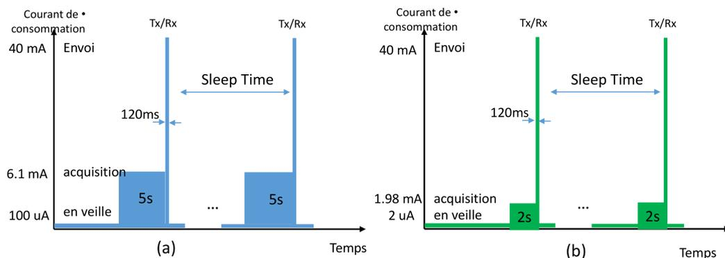
FIGURE 5.16 – La consommation d'énergie du nœud capteur avec un module de communication ZigBee : (a) ancienne version, (b) version optimisée.
