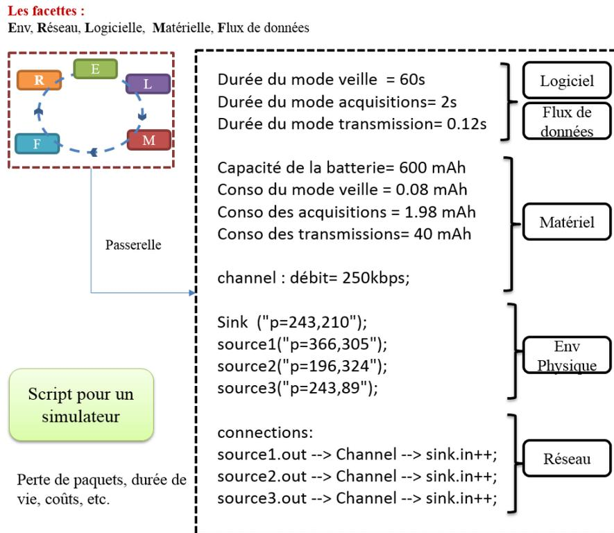
FIGURE 4.14 – Transformations de modèles pour les analyses/simulations.
