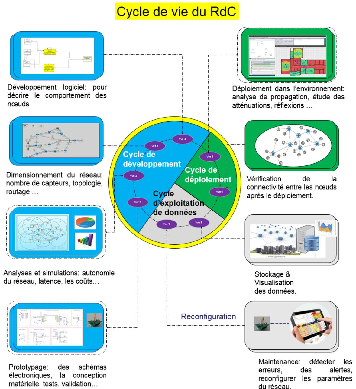
FIGURE 3.2 – Cycle de vie d'un réseau de capteurs.
