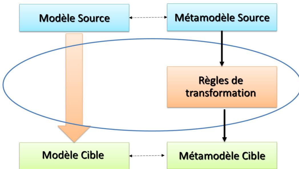
FIGURE 2.3 – Transformations de modèles dans l'approche IDM.
