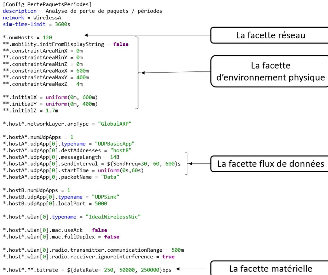
FIGURE 5.19 – Script de simulation pour le simulateur Omnet++.
