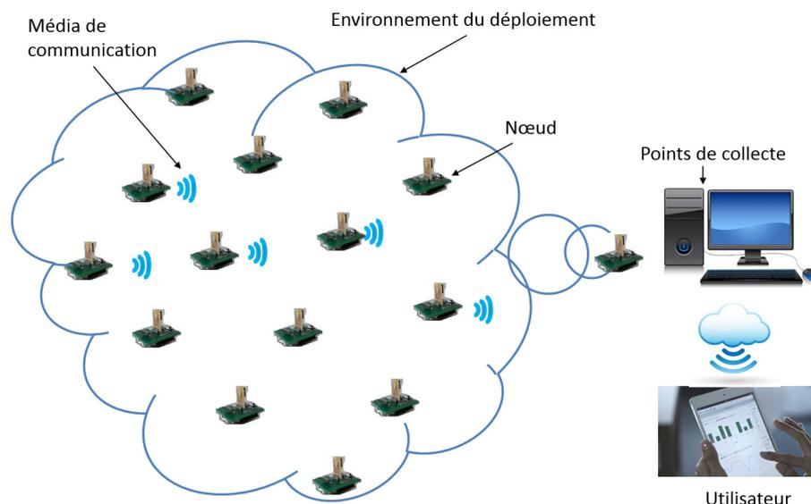
FIGURE 1.3 – Architecture de réseau de capteurs.
