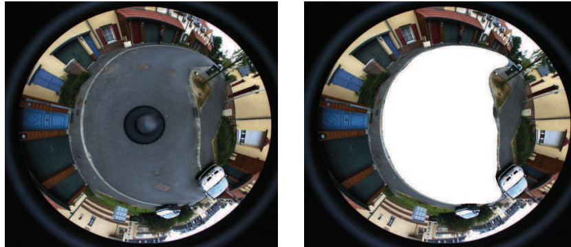
FIGURE 5.11 – Image omnidirectionnelle prise par une caméra catadioptrique et l'espace libre extrait dans l'image (zone blanche).
