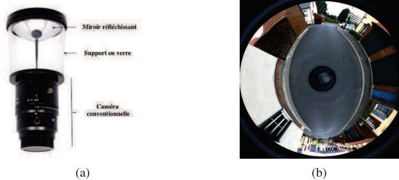
FIGURE 2.4 – (a) Caméra catadioptrique AXIS M3007-PV . (b) Exemple d'image acquise.
