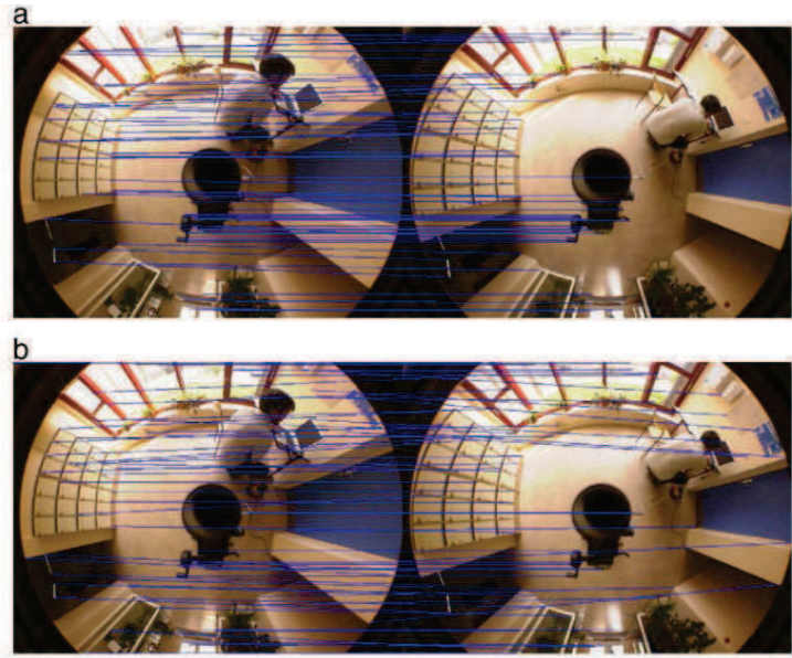
FIGURE 4.5 – Mise en correspondance de points d'intérêt par ZNCC (Zero mean Normalized Cross-Correlation). (a) Méthode classique Euclidienne : 65 correspondances au total, 53 correspondances correctes. (b) Méthode géodésique : 71 correspondances au total, 63 correspondances correctes.
