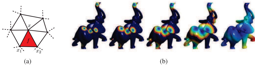
FIGURE 5.10 – (a) Maillage triangulaire. (b) Exemple de propagation par Fast Marching sur un domaine triangulé (Source [Peyré and Cohen, 2009]).
