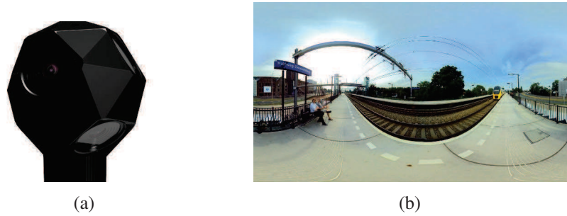
FIGURE 2.1 – (a) Caméra Sphericam 2 . (b) Exemple d'image acquise.
