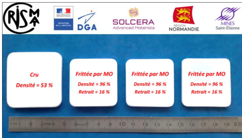
Figure 84 : Photographie des échantillons frittés au sein du four micro-ondes monomode 915 MHz
