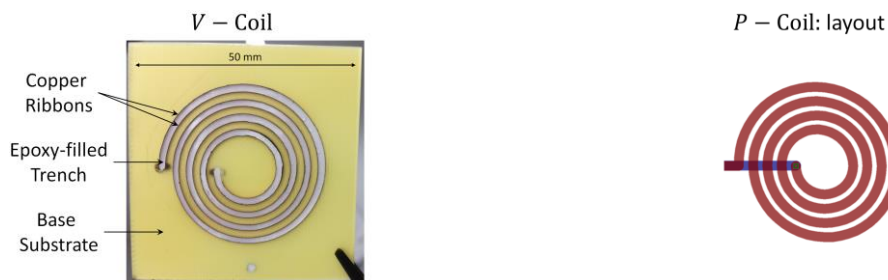
Figure I.29 : photographie de la V-coil avant ajout des plaques magnétiques (gauche) et layout de la P-coil (droite). Les deux figures sont à la même échelle.
