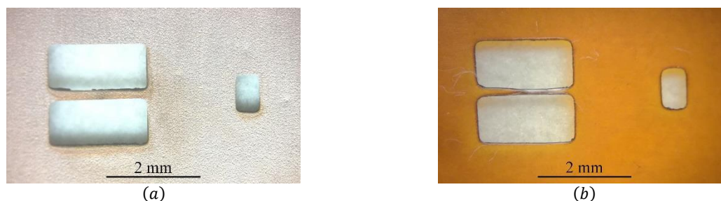
Figure III.20 : (a) : pochoir en cuivre utilisé pour réaliser le masque (b) pour un MOSFET SiC CPM2-1200-0040b.
