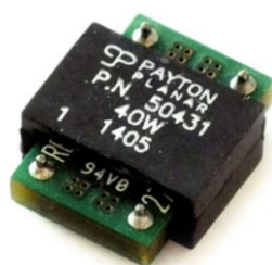
Figure I.4 : transformateur planar rapporté (16 mm × 19 mm × 6,4 mm ; 40 W – 600 kHz) [36].
