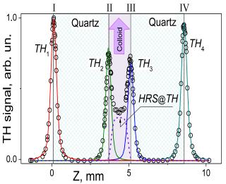
Figure 1 : Signal THG obtenu par balayage à travers une cuvette de silice contenant une suspension de nanoparticules de ZnO de taille ~150 nm dans l'éthanol (concentration  $1.4 \times 10^{-2}$  mg/mL). On observe quatre pics aux interfaces I, II, III, IV et un signal de diffusion de troisième harmonique au centre de la cuvette (HRS@TH) [77].
