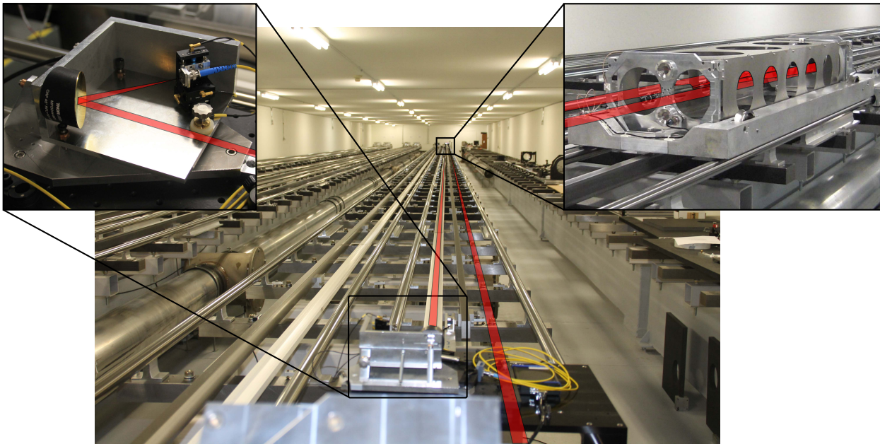
FIGURE 5.7 – Dispositif permettant le passage dans les lignes à retard de CHARA. En haut à gauche, le module de collimation, en haut à droite le chariot de la ligne à retard et au centre la ligne à retard proprement dite. Le module de réinjection est positionné sur une table optique hors champ.
