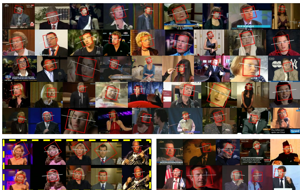
FIGURE 1.14 – Bonnes (cinq premières lignes) et mauvaises (deux dernières lignes) estimations dans le corpus YouTube Faces C. La ligne blanche indique la véritable orientation annotée manuellement.
