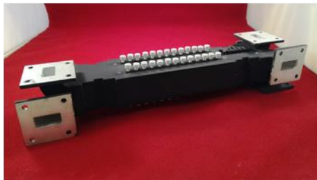
Figure 33 : Photographies et réponses en fréquences du diplexeur compact réalisé
