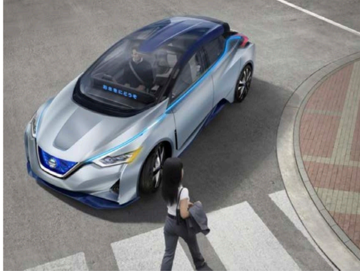
Figure 133 : Concept Nissan IDS dotée de l'indicateur d'intention représenté par la ligne bleue qui court le long des flancs du véhicule. Un système d'indications textuelles complémentaires est intégré derrière le pare-brise
