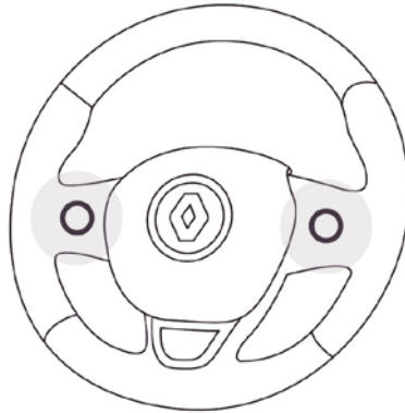
Figure 109 : Mise en surbrillance des deux boutons de reprise en main pour le conducteur
