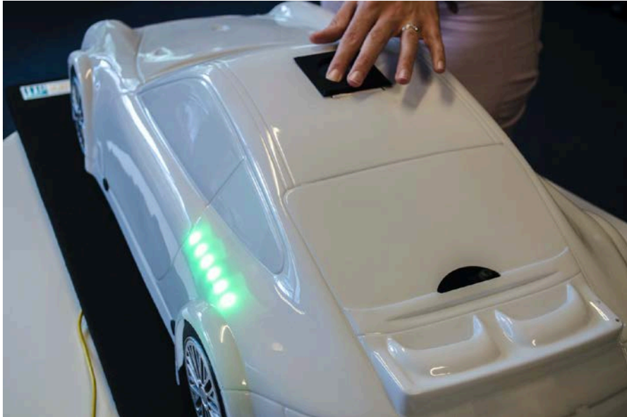
Figure 75 : maquette de principe, doté d'un pavé tactile sur son sommet et d'un ruban de LED intégré sous la carrosserie. Les mouvements circulaires du doigt du participant sur le bouton sont visuellement reproduits sur le bandeau de LED
