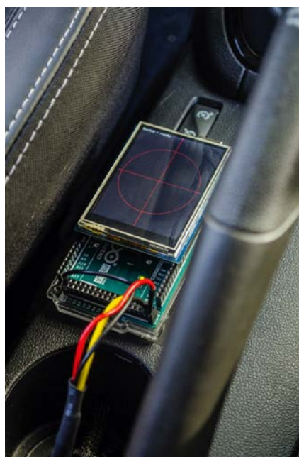
Figure 125 : Dispositif Arduino intégré dans le véhicule, situé au niveau du frein à main et accessible au conducteur pour éviter de contraindre les mouvements du volant avec les fils du système.
