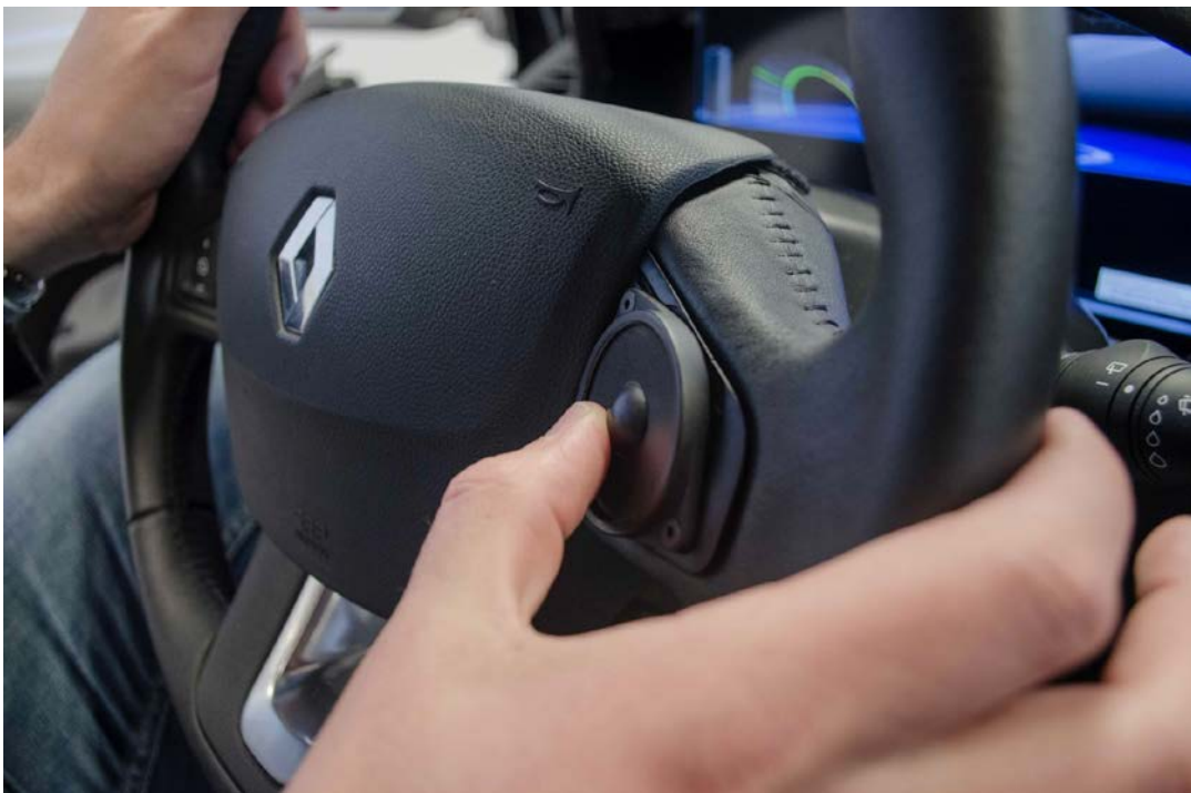
Figure 71 : Bouton de EyeZ intégré sur le volant du simulateur
