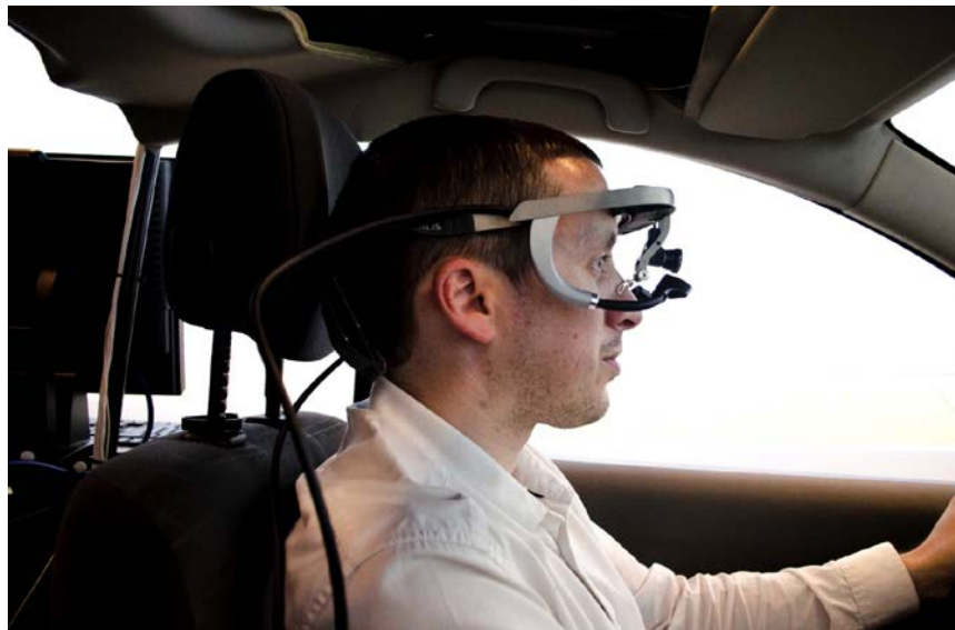
Figure 77 : installation et calibrage de l'occulomètre
