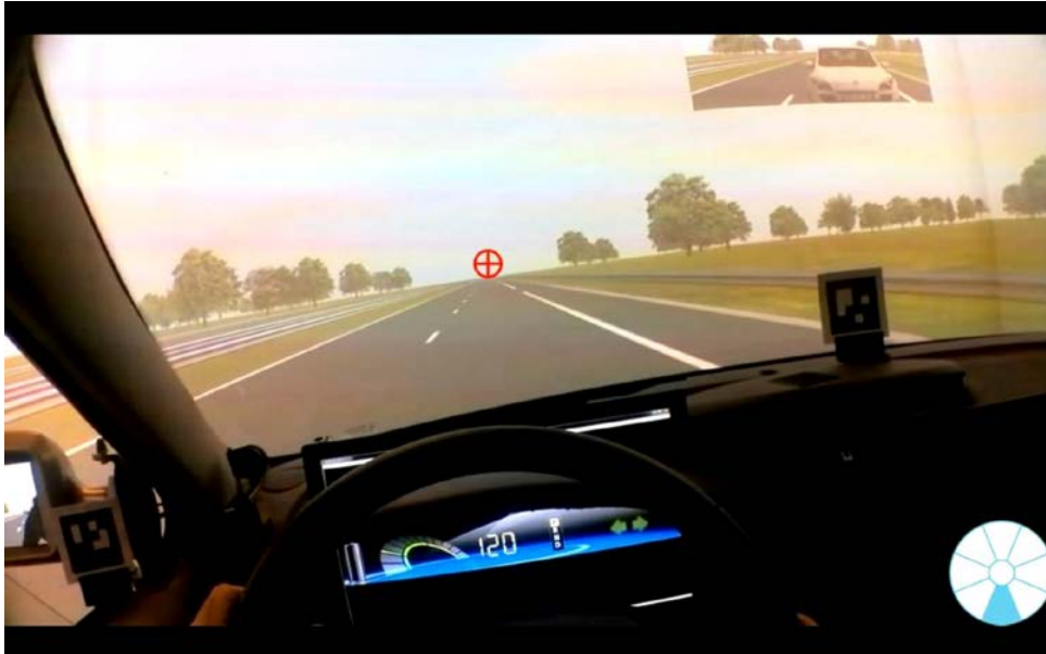
Figure 100 : La vidéo du scénario S1c intègre la direction de l'attention du conducteur (croix rouge) ainsi que l'utilisation qu'il fait du bouton. Celui-ci s'affiche en bas à droite de l'écran lorsque le participant met son doigt au contact de la surface tactile. Nous avons zoné en huit parties le bouton pour indiquer précisément quelle zone est concernée par l'exploration tactile du participant.
