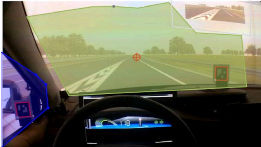
Figure 79 : Zonage de L'attention visuelle du participant. La zone bleue correspond au rétroviseur gauche, la zone grise au rétroviseur central, la zone verte au pare-brise (le rétroviseur droit n'apparaît pas sur l'image). Les QR Code (encadrés en rouge) permettent de détecter automatiquement les zones pendant la conduite malgré les mouvements de tête du sujet équipé de l'occulomètre.
