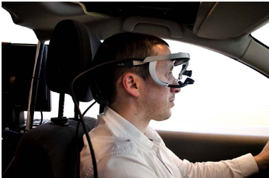
Figure 77 : installation et calibrage de l'occulomètre
