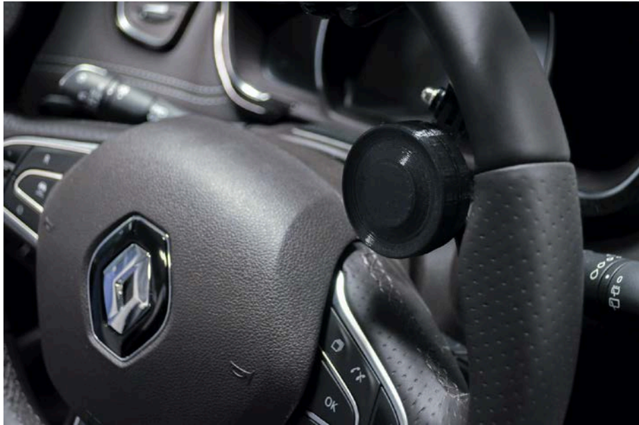
Figure 65 : modélisation et intégration du profil 1 sur le volant pour évaluer le ressenti des participants en termes de manipulation
