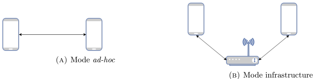
FIGURE 1.2: Communication en mode ad-hoc et infrastructure
