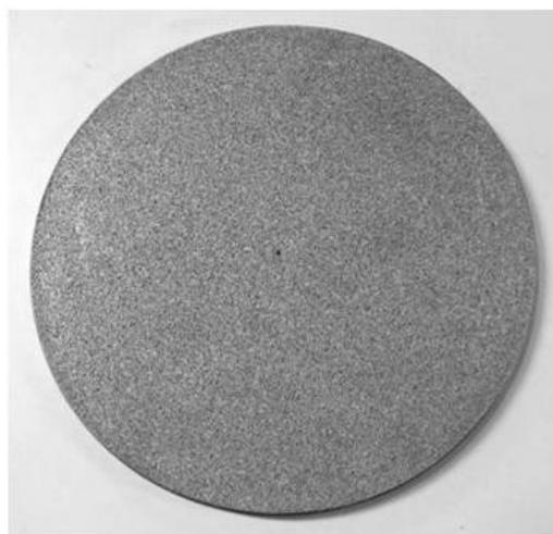
**Figure III.3 : Disque d'inox (316L) poreux (diffuseur de gaz avec  $\varepsilon_{diff}=50\%$  et  $k_{diff}=1,12 \cdot 10^{-10} m^2$ ) (Tridelta SiperM; R200; diamètre 20cm, épaisseur 1cm, 1,2kg) Perméabilité vérifiée expérimentalement en Annexe XIII**
