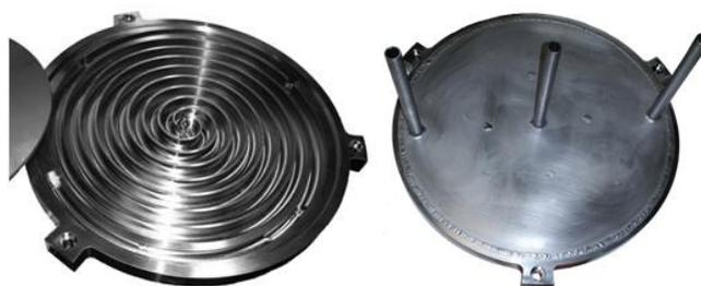
**Figure III.5 : Vue de la face inférieure de l'échangeur de chaleur avant et après soudures**
