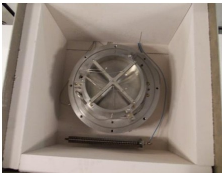
Figure AVIII.3 : Vue de dessus de l'enceinte thermo-régulée avec à l'intérieur le réacteur ouvert (cloche retirée) et l'une des résistances à ailettes
