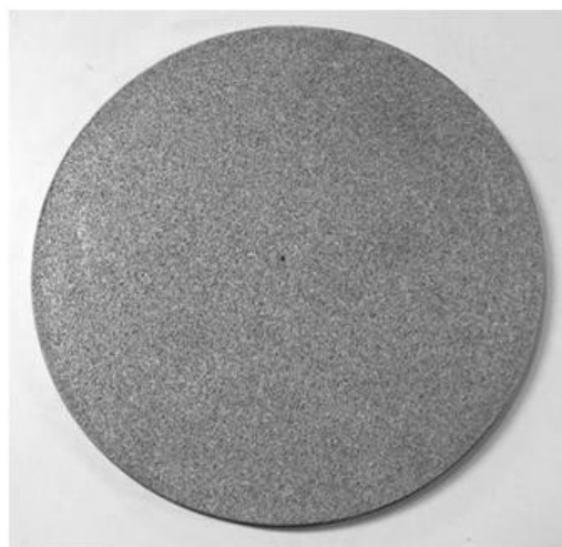
Figure III.3 : Disque d'inox (316L) poreux (diffuseur de gaz avec \epsilon_{diff}=50\% et k_{diff}=1,12 \cdot 10^{-10} m^2 ) (Tridelta SiperM; R200; diamètre 20cm, épaisseur 1cm, 1,2kg) Perméabilité vérifiée expérimentalement en Annexe XIII
