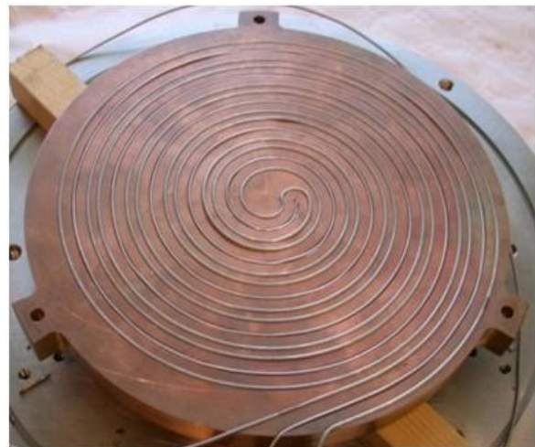
Figure III.7 : Vue de dessus de l'échangeur de chaleur après assemblage avec la résistance chauffante et le thermocouple de régulation.
