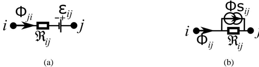
Figure 2.5. Branche du réseau de perméances avec : (a) source de force magnétomotrice ; (b) source de flux.
