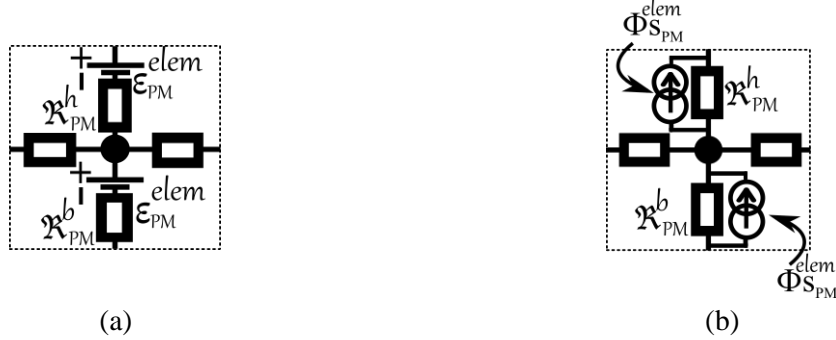
Figure 2.14. Bloc élémentaire de l'aimant avec : (a) des sources de f.m.m ; (b) des sources de flux
