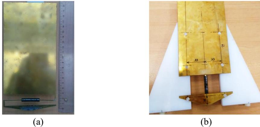
Figure 3-69 (a) Antenne monopole A1-TC réalisée. (b) Antenne monopole A2-TC réalisée.
