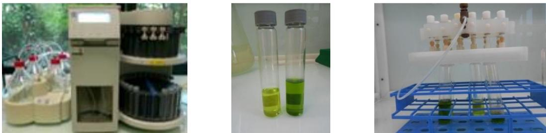
Figure 19: Photographies de l'appareil ASE à gauche, de vials de récupération contenant des échantillons au milieu, et le système d'évaporation sous flux d'azote des échantillons à droite
