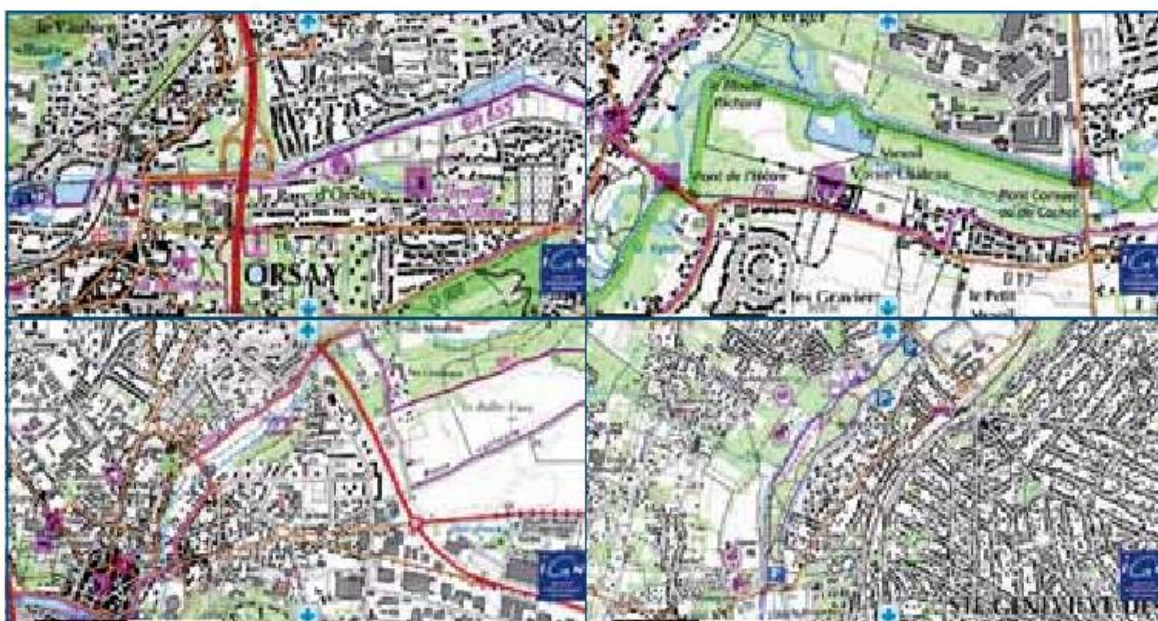
↑ Figure 40 : Quatre exemples de cours d'eau en traversée urbaine ou périurbaine. Le tracé est généralement rectiligne et les berges longées par des routes ou des chemins, donc protégées contre l'érosion (source : Géoportail, IGN). ≡
