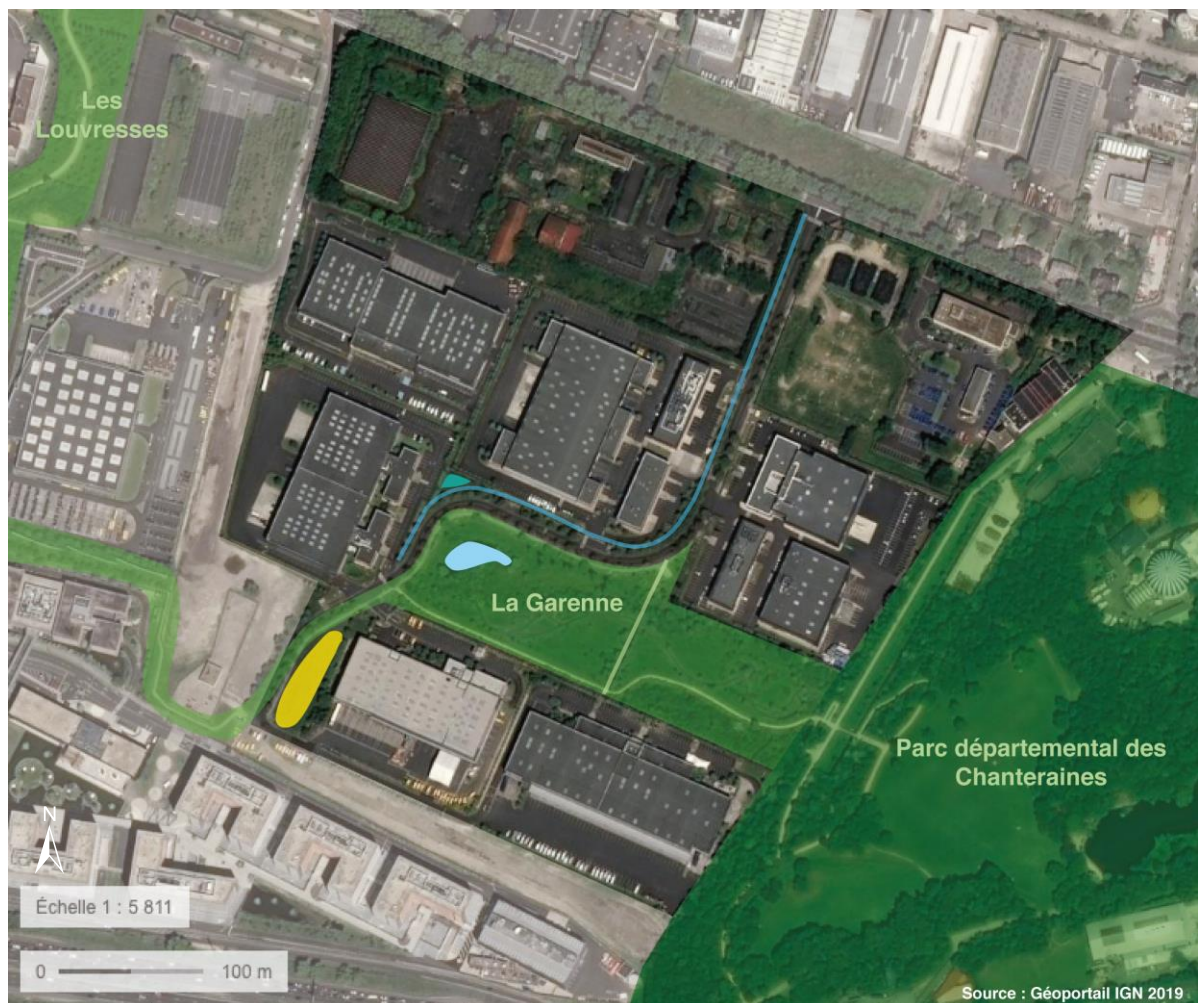
Figure 7.30 Zone humide (en bleu pâle), bassins secs (en jaune) et noues (lignes bleues) de la zone d'activités des Chanteraines et parc (en vert)
