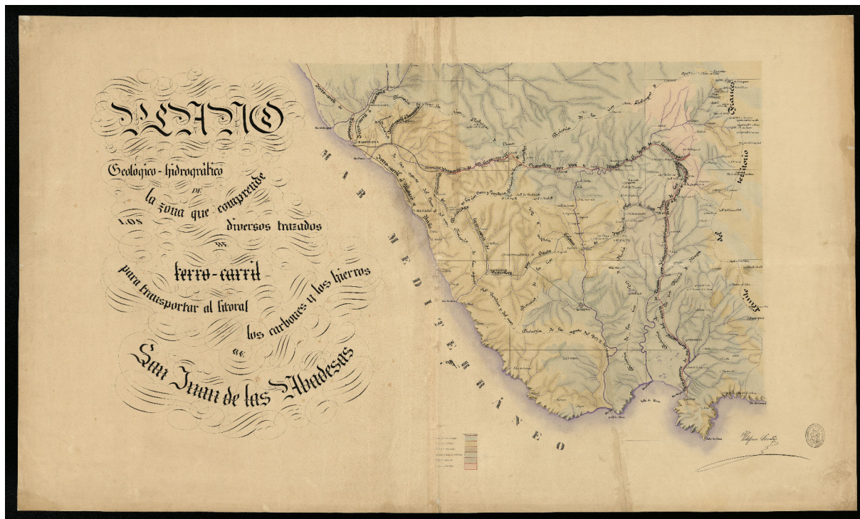
Diario geológico-hidrográfico de la zona que comprende los diversos trazados ferro-carril para transportar al litoral los carbones y los hierros de San Juan de las Abadessas, in Ildefonso Cerdá, Planos de un proyecto de ferrocarril (de Granollers a San Juan de las Abadessas), 1856, Institut Cartogràfic i Geològic de Catalunya
