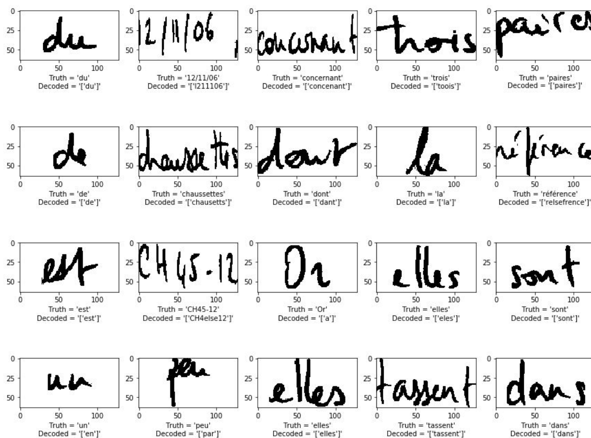
Figure 69.: Résultats de la reconnaissance de l'écriture manuscrite par les réseaux de neurones
