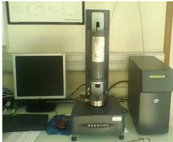
Figure 51: Rhéomètre AR-G2 (TA Instruments, France)
