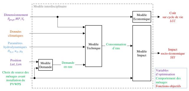
figure 5 – Synoptique du modèle interdisciplinaire.
