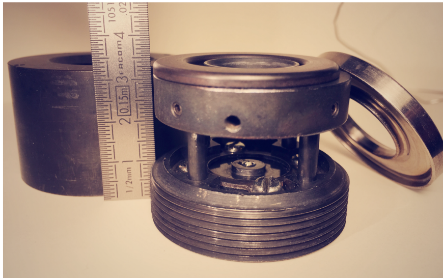
FIGURE 3.3 – Photo d’une cellule à enclumes de diamant à membrane. Au centre, la cellule ouverte avec les deux parties, on peut voir un diamant sur la partie inférieure. L’anneau est posé sur la partie supérieure. À droite la membrane et à gauche le capot qu’on visse pour refermer la cellule. Le réglet sert d’échelle.
