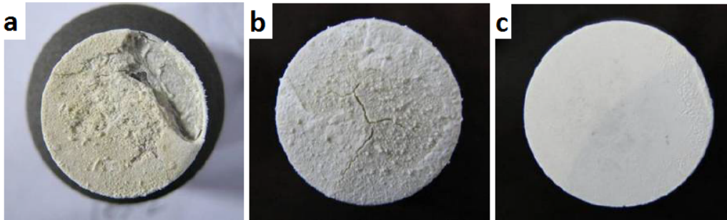
FIGURE 1.9.13 – Photographies après test sous condition 1 des échantillons (a) ZS10, (b) ZS15 et (c) ZS30. [39]
