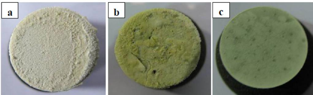
FIGURE 1.9.14 – Photographies après test sous condition 1 des échantillons (a) ZS10, (b) ZS15 et (c) ZS30. [39]
