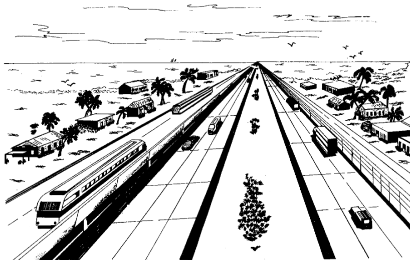
Figure 38. Principe du jumelage d'infrastructure en élévation (1977) 1238
