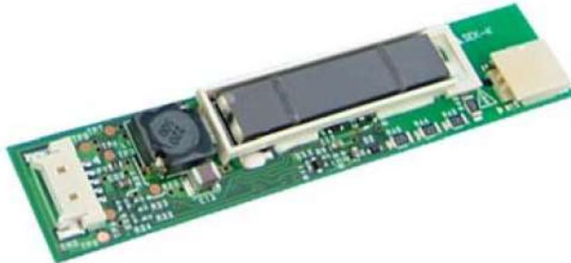
*Figure 0.2 : Convertisseur DC-AC pour rétroéclairage LCD [6]*
