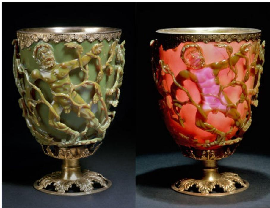
**Figure I.11 : Coupe de Lycurgue.** Les nanoparticules d'argent et d'or insérées dans la coupe lui donne une couleur verte qui devient rouge lorsque de la lumière est insérée à l'intérieure de la coupe. (Source : British Museum)
