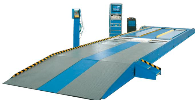
**Figure I.8 : Décéléromètre** Le décéléromètre est un dispositif qui permet de mimer le freinage d'une voiture en appliquant une vitesse donnée et un scénario de freinage précis au système de roulement sur une plateforme fixe. (Source : <http://www.equipgaragefrance.fr>)
