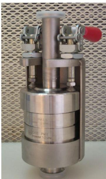
**Figure I.9 : Impacteur en cascade :** Il existe différentes formes d'impacteurs, dispositifs communément utilisés pour le prélèvement de particules en fonction de leur taille. (Source : <https://lcpa.univ-littoral.fr/equipements/prelevements-et-analyse-des-aerosols-inorganiques/>)
