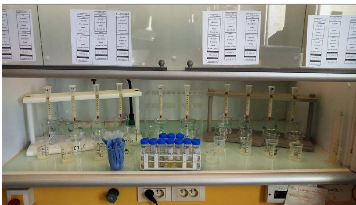
Figure I.16. Colonnes de résines échangeuses d'ions.
