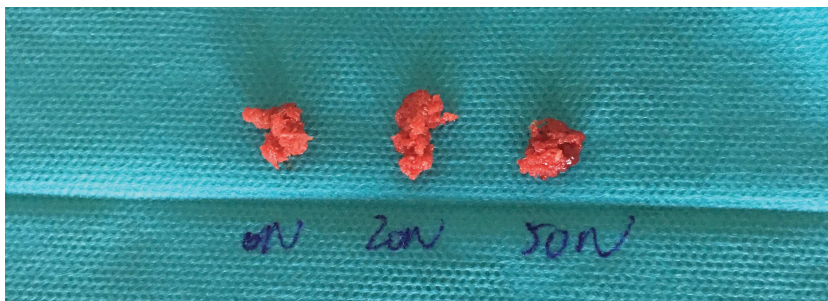
Figure 51 : Tas de copeaux de poids équivalents prêts à être transférés dans les socles internes stériles de la machine à compaction.
