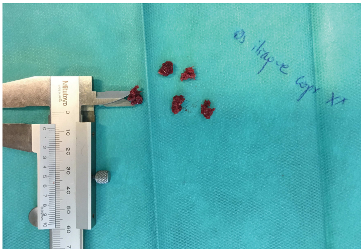
Figure 56 : Copeaux d'os iliaque issu de déchets opératoires, prélevés à la curette de 4x6mm.
