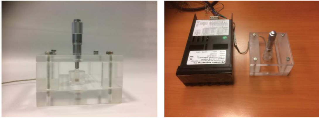
Fig. 46 : Photos de la machine à compaction – prototype final
