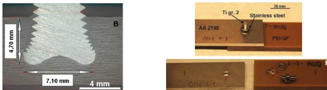
Figure 1-25: Vue en coupe d'un joint avec rivet fileté, assemblage des substrats AA2198 et PEI-GF avant et après sollicitation en traction-cisaillement [74]
