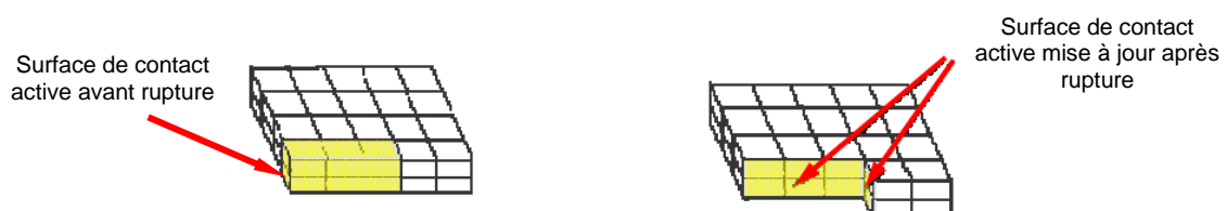
Figure 2-18: Gestion des éléments rompus du maillage dans le logiciel Abaqus 6.10-1® (source ABAQUS [119])
