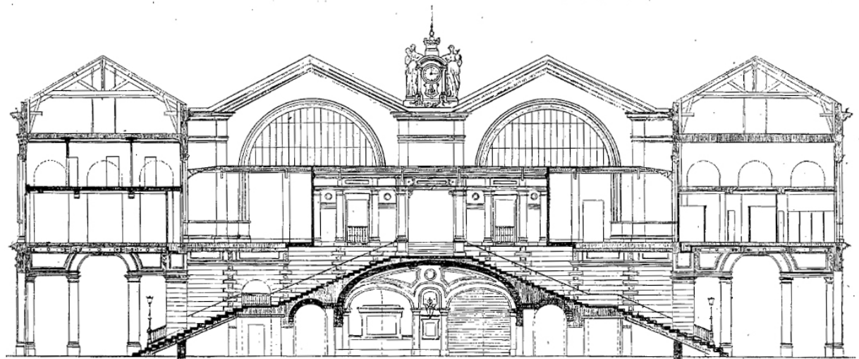
GARE MONTPARNASSE. — Coupe de la nouvelle façade.
