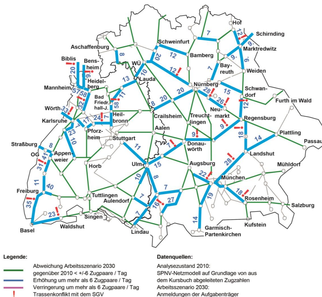
fig. 136 : Augmentations du nombre de trains dans le scénario de travail 2030 par rapport à l'état de l'analyse 2010 dans les Länder du sud de l'Allemagne (BW + Bavière) - (source : Verkehrsverflechtungsprognose 2030, p.216)
