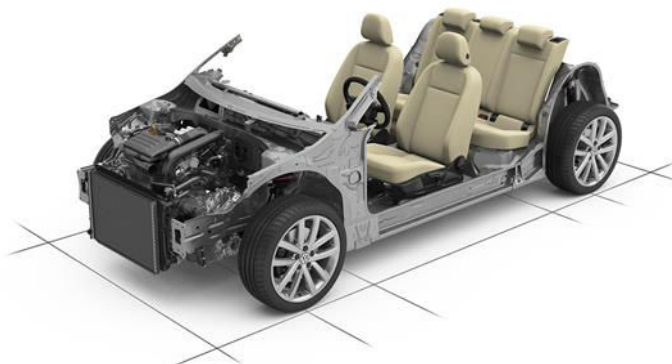
Figure 1.2 – Utilisation de plateformes modulaires : l'exemple du groupe Volkswagen 2
