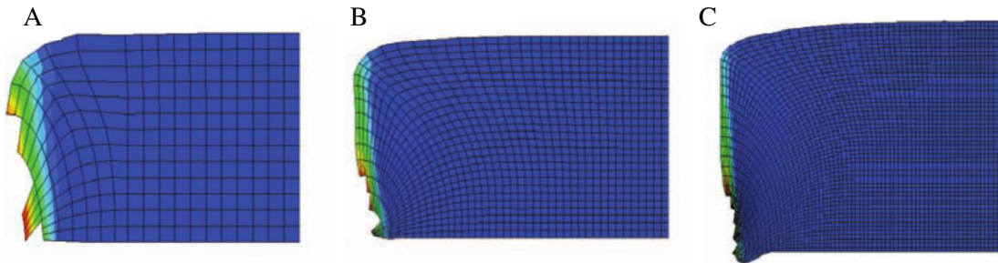
Figure 2.29 – Profils de bord découpé pour une tôle DC04 de 0,67 mm d'épaisseur et un jeu de 0,03 mm pour trois tailles de mailles, d'après [Ramde2010]. (A) 60 \mu\text{m} . (B) 30 \mu\text{m} . (C) 15 \mu\text{m}
