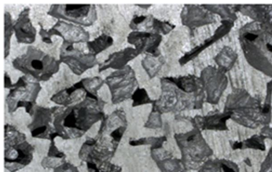
Figure 6.6 Observation de la structure de mousse d'aluminium à faible porosité (MAFP)
