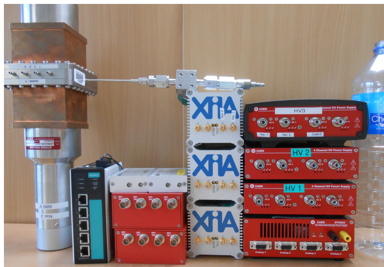
FIGURE 4.3 – Photographie du système MARGOT et de sa chaîne d'alimentation et de traitement du signal. Les câbles ont été retirés pour plus visibilité.
