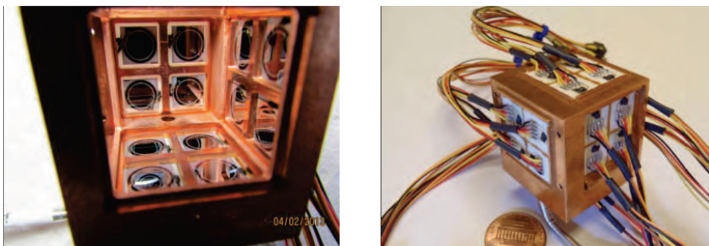
FIGURE 1.20 – Gauche : vue interne de la cellule gaz du détecteur 24 x Si-PIN. Droite : vue externe. Images tirées de [Cox et al., 2013].
