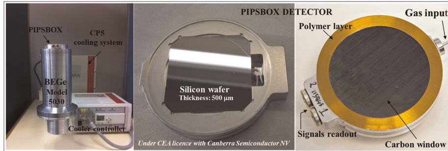
FIGURE 1.13 – Gauche : détecteur PIPSBox TM posé sur la fenêtre d'entrée d'un détecteur germanium de type BeGe. Centre : détecteur PIPSBox TM ouvert (sans les fenêtres de carbone). Droite : détecteur PIPSBox TM complet. Image tirée de [Le Petit et al., 2015].
