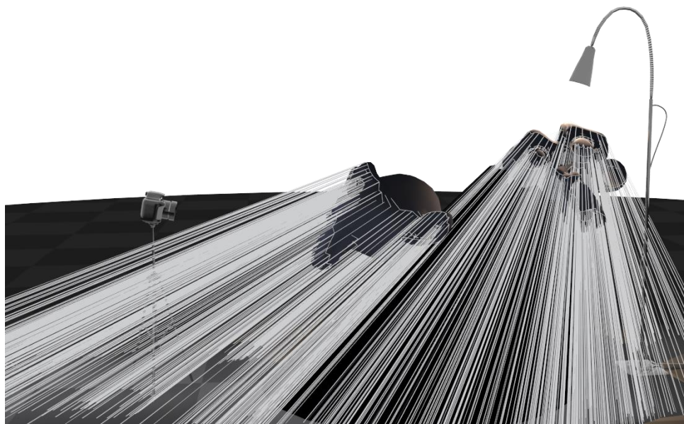
FIGURE 1.15 – Un recouvrement important des volumes d'ombre (dont les contours sont affichés en blanc), surtout lorsqu'ils couvrent la majeure partie de l'écran, comme c'est le cas pour la caméra située à gauche de la scène, peut sérieusement ralentir la méthode. Source [80]
