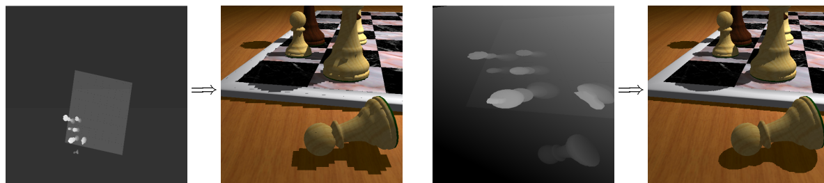
FIGURE 1.8 – À gauche, utilisation d'une shadow map classique. À droite, le calcul de la shadow map après la transformation perspective de la caméra donne une plus grande importance aux objets proches de la caméra. Par conséquent, les artefacts sont nettement diminués pour les ombres proches de la caméra. Source [82]
