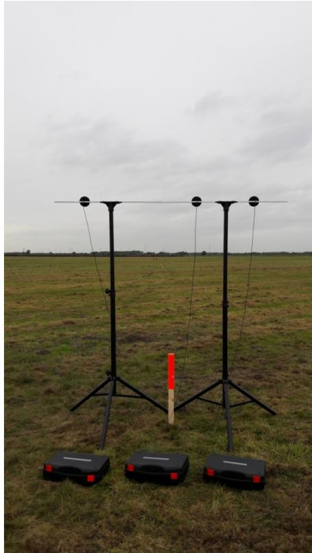
FIG. 4.3 : Barre de 3 microphones avec boules anti-vent. Chaque microphone dispose de son propre module d'acquisition autonome.
