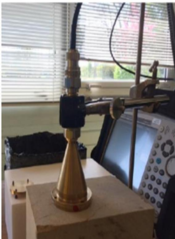
Figure III. 19 : Système de mesure de la sonde coaxiale
