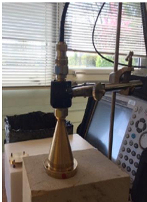
Figure III. 19 : Système de mesure de la sonde coaxiale
