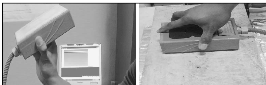
Figure III. 7 : Prise de mesure en fixed-offset
