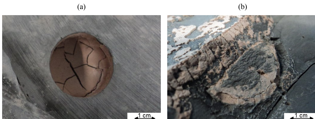
Figure 28. Photographies (a) en surface et (b) à cœur d'un échantillon S1M1A650 coulé dans un bloc d'argilites (coulage et stockage à 20 °C).
