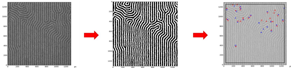
Figure II - 21: Différentes étapes de traitement d'une image par le logiciel Deboara pour la mesure du nombre de défauts
