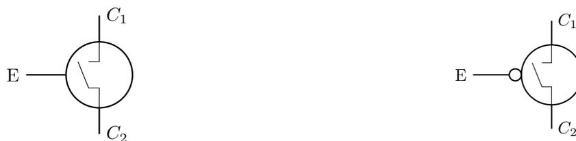
FIGURE 2.2 – (E) Entrée qui commande l'ouverture ou la fermeture de la connexion entre ( $C_1$ ) et ( $C_2$ ). À gauche, un transistor classique, à droite un transistor inverse.
