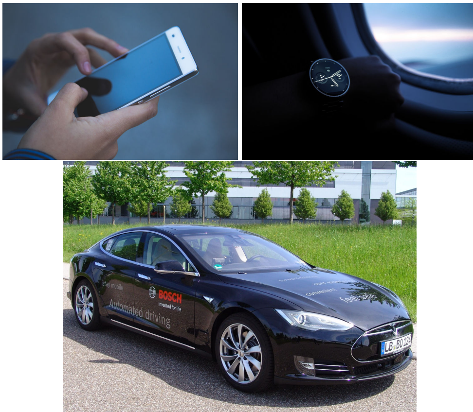
FIGURE 2.1 – Différentes architectures pour différents usages. Un smartphone utilisera l'ISA ARM-A, la montre plutôt ARM-M et la voiture autonome implémentera un système temps-réel ARM-R.
