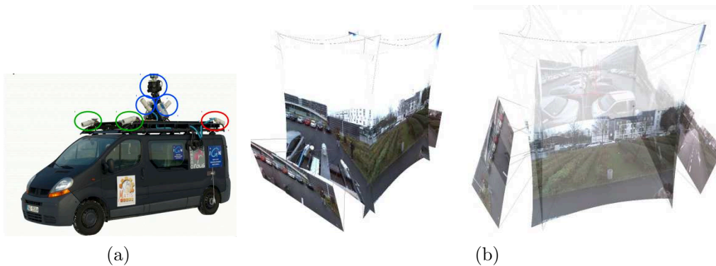
FIGURE 1.8 – (a) Système de caméras STEREOPOLIS utilisé par l'IGN [2] : un système panoramique en bleu et deux paires stéréoscopiques avant et arrière en vert. (b) les images utilisées pour construire les images panoramiques.
