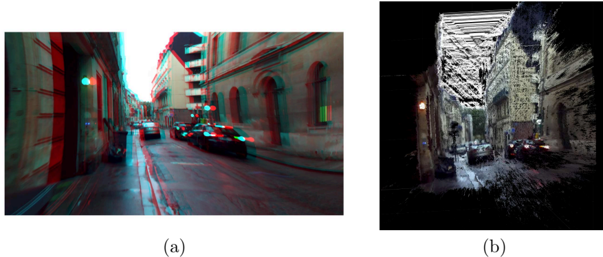
FIGURE 3.23 – (a) La rectification d’une image agent droite et une image gauche (b) La construction d’un nuage 3D agent à partir de deux images gauche-droite
