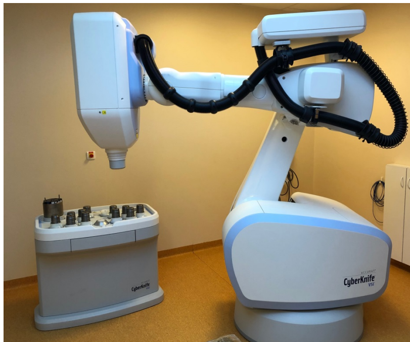
Figure 3.2. Cyberknife VSI 1000 UM/min du CFB et ses collimateurs fixes.
