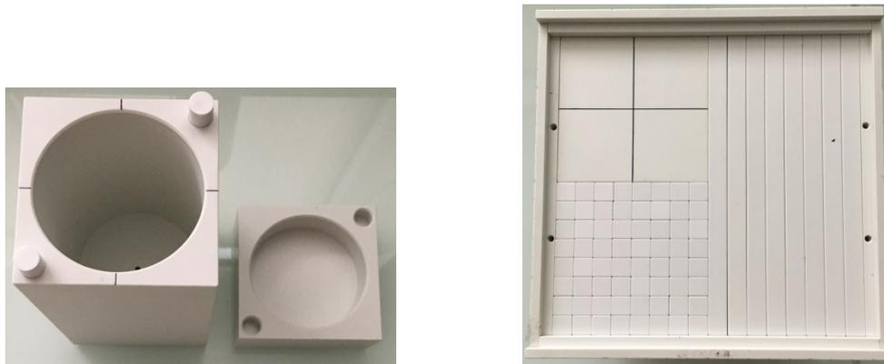
[Figure 2.5](#). Insert en RW3 pour les gels dosimétriques de 400 mL et son couvercle (gauche) et placement de l'insert dans l'EasyCube (en configuration homogène de RW3) (droite)
