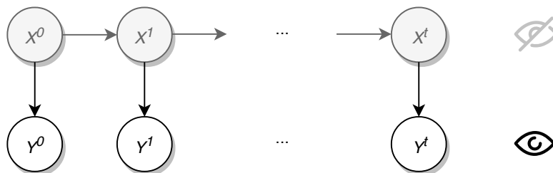
FIGURE 3.4 – Exemple de modèle de Markov caché. Les variables X sont des variables latentes , non observables, et forment une chaîne de Markov. Seules les variables Y , des observations émises par l'environnement, sont perceptibles.
