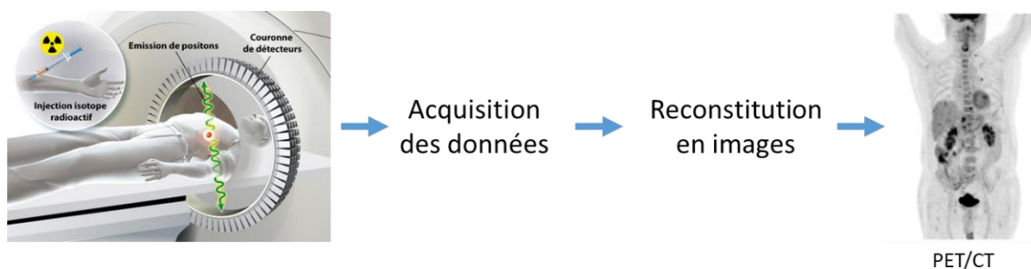
Figure 9 : Principe de l'imagerie TEP.
