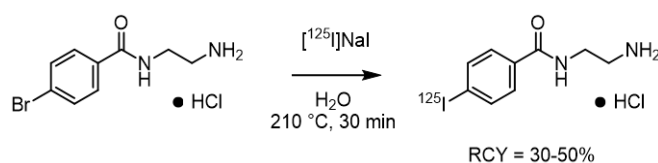
Figure 41 : Radio-iodation par échange interhalogène. 22
